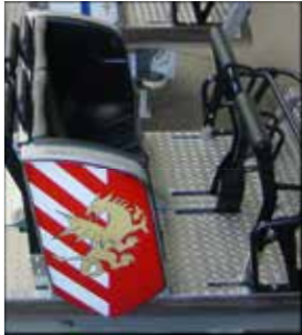
Mechanische Schoßbügel mit optionaler Bügelüberwachung Mechanical lap restraints with optional monitoring
