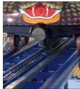
Kettenlift mit geräuschloser Rücklaufklinke chain lift with silent anti-rollback dog
