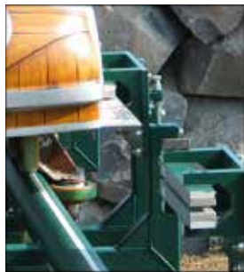
Verschleißfreie lineare Wirbelstrombremsen Durable magnetic brakes
